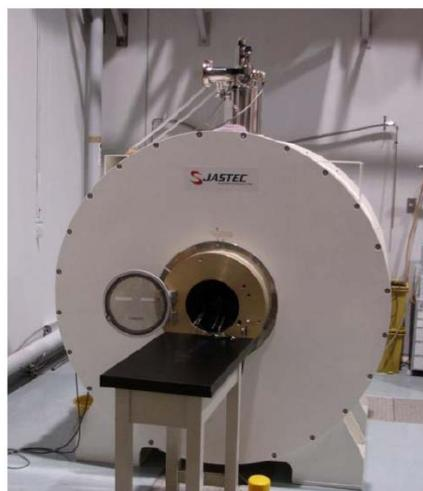
図 6：磁場強度 4.7 T の MRI 装置
